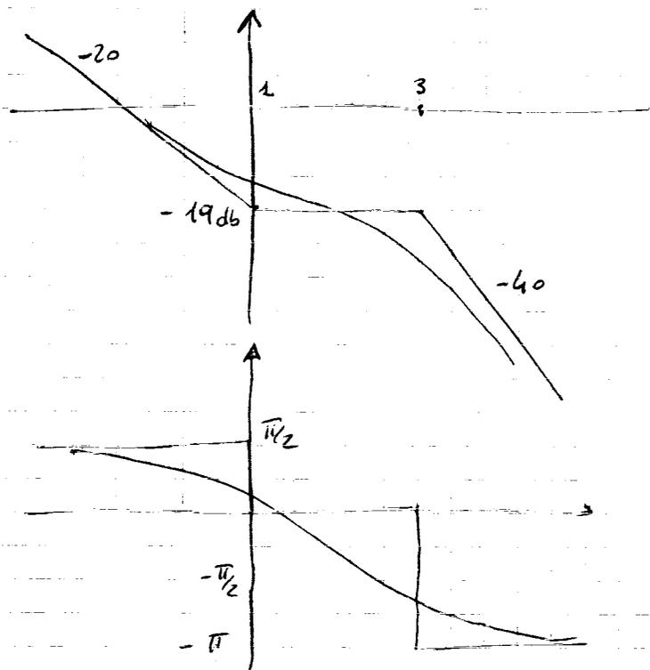
$$2) V(\omega) = \frac{j\omega - 1}{j\omega[(9-\omega^2)^2 + 9\omega^2]}$$
