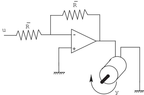
Si tratta di un motore in continua alimentato da un amplificatore operazionale. Siano  $J$  il momento di inerzia e  $b$  la costante di attrito del motore,  $R$  la resistenza e  $L$  l'induttanza del motore e  $H$  la costante elettromeccanica. Supponiamo inoltre che l'amplificatore operazionale abbia amplificazione  $A$ .
