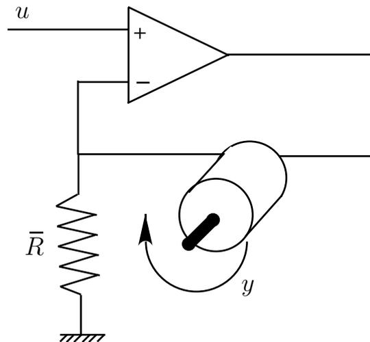
Si tratta di un motore in continua alimentato da un amplificatore operazionale. Siano  $J$  il momento di inerzia e  $b$  la costante di attrito del motore,  $R$  la resistenza e  $L$  l'induttanza del motore e  $H$  la costante elettromeccanica. Supponiamo inoltre che l'amplificatore operazionale abbia amplificazione finita, ma molto elevata  $A$ .
