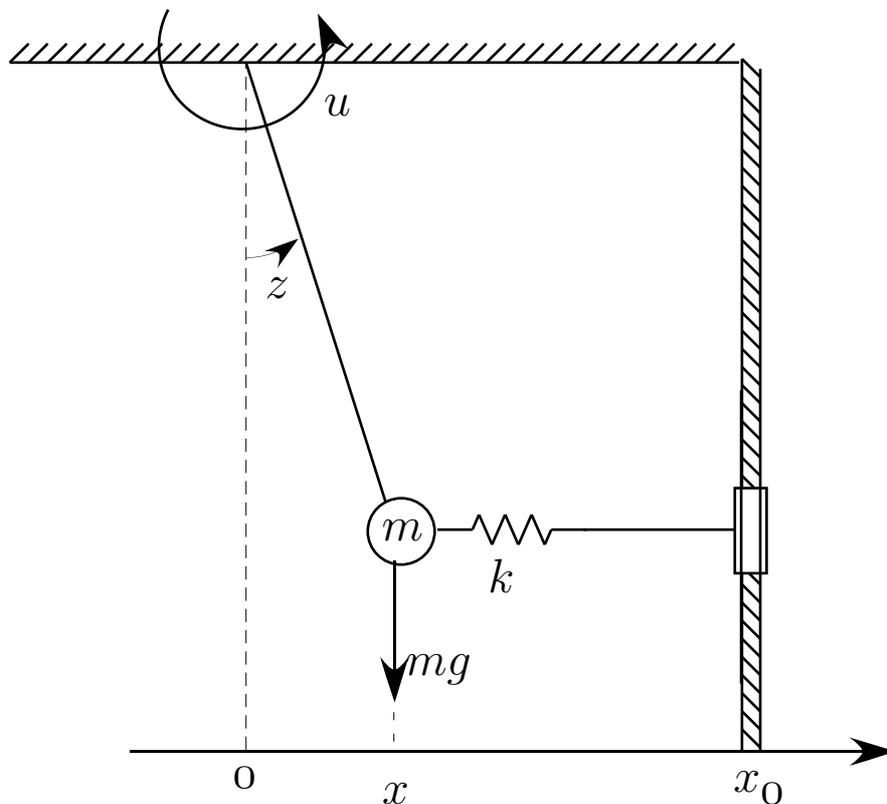
Si tratta di un pendolo sul quale agisce una coppia  $u$ , incernierato in un perno sul quale ruota con costante di attrito viscoso rotazionale trascurabile. Sia  $y$  la posizione angolare,  $m$  la massa dell'estremità del pendolo e  $l$  la sua lunghezza. Sia  $g$  la accelerazione di gravità. Si suppone che il pendolo sia incernierato a una molla (con lunghezza a riposo nulla) la cui altra estremità scorre lungo la parete in maniera tale che la molla sia sempre orizzontale.
