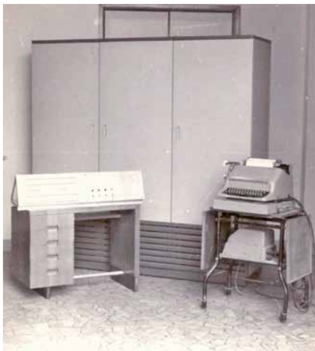
FIG. 4 - Il calcolatore elettronico dell'Istituto di Statistica racchiuso nell'armadio, completo di pannello di controllo, a sinistra, e periferiche di Input/Output (I/O), a destra. (La fotografia è stata gentilmente resa disponibile da Francesco Contin).
