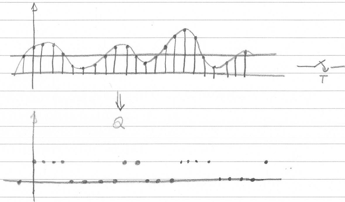
Questa distorsione è molto difficile da evitare, però se la quantizzazione è sufficientemente fine la distorsione si può trascurare. In generale la quantizzazione si modellizza con un rumore additivo  $N(t)$  con  $|N(t)| < \frac{q}{2}$ .
