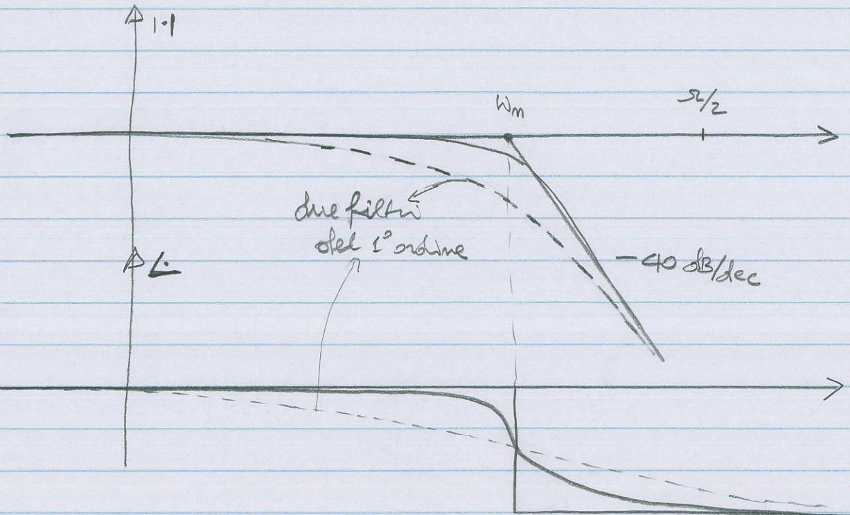
Questo filtro attenua i problemi del filtro del 1° ordine. Tuttavia, introduce anch'esso distorsioni e interidi in bande che possono essere mortali per la stabilità o il margine di fase (prontezza) del sistema a catena chiusa.
