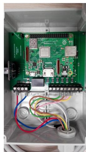
comporta come un sistema controllato in tensione. E' bastato quindi connettere, per mezzo di una resistenza, l'uscita del quadripolo a due PIN del Raspberry (GPIO e massa), in modo da poter associare la presenza di tensione ad un possibile evento temporalesco all'esterno. Il nuovo componente ha comportato un'integrazione ulteriore anche nel codice di lettura e nella relativa implementazione del trasferimento dati tra Rpi-IoT, smartphone e webGIS.
