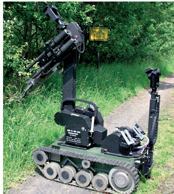
Fig. 31.8 tEODor, A telerobotic system for disarming of explosives. (Courtesy telerob Gesellschaft für Fernhantierungstechnik mbH, Ostfildern, Germany)
