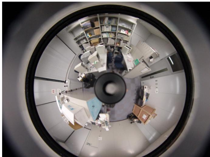
**Figura 1.4:** Esempio di immagine omnidirezionale
