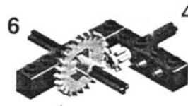
**Figura 2.2** bevel gear
