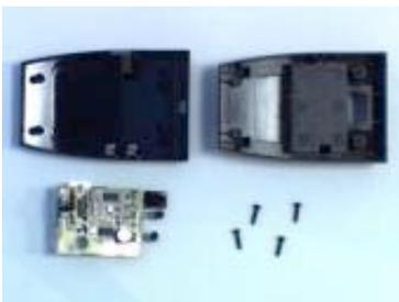
Figura 2.11 Trasmittitore IR smontato
