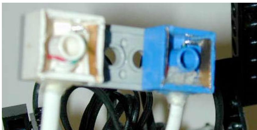
**Figura 9.5** Connettori del sensore di rotazione
