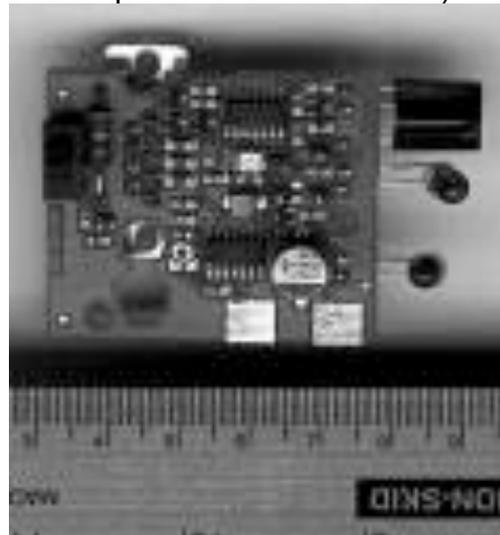
Figura 2.12 interno del Trasmittitore IR
