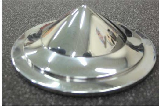
Figura B.2: Lo specchio omnidirezionale: la zona esterna serve per vedere le zone in prossimità del robot
