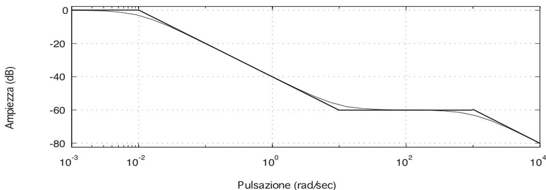
L'andamento monotono della risposta in frequenza ci permette di dire che non ci sono nè pulsazione di risonanza nè picco di risonanza relativo. Per valutare la banda passante, vista la distanza reciproca di poli e zeri, possiamo utilizzare come rappresentazione approssimata della risposta in frequenza la seguente:
