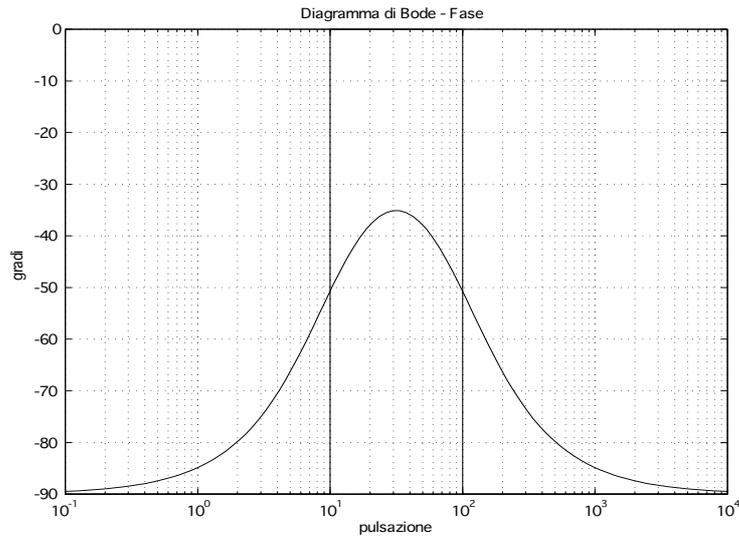
ed è immediato rendersi conto del fatto che la pulsazione  $\omega_A$  si trova esattamente in corrispondenza a  $10^3$  rad/s, mentre il margine di fase in corrispondenza alla pulsazione  $\omega_A^* = 500$  rad/sec è superiore a  $90^\circ$ . Per compensare il fatto che  $\omega_A > \omega_A^*$  e  $m_\psi(\omega_A^*) > m_\psi^* := 45^\circ$  potremmo utilizzare un'azione attenuatrice:
