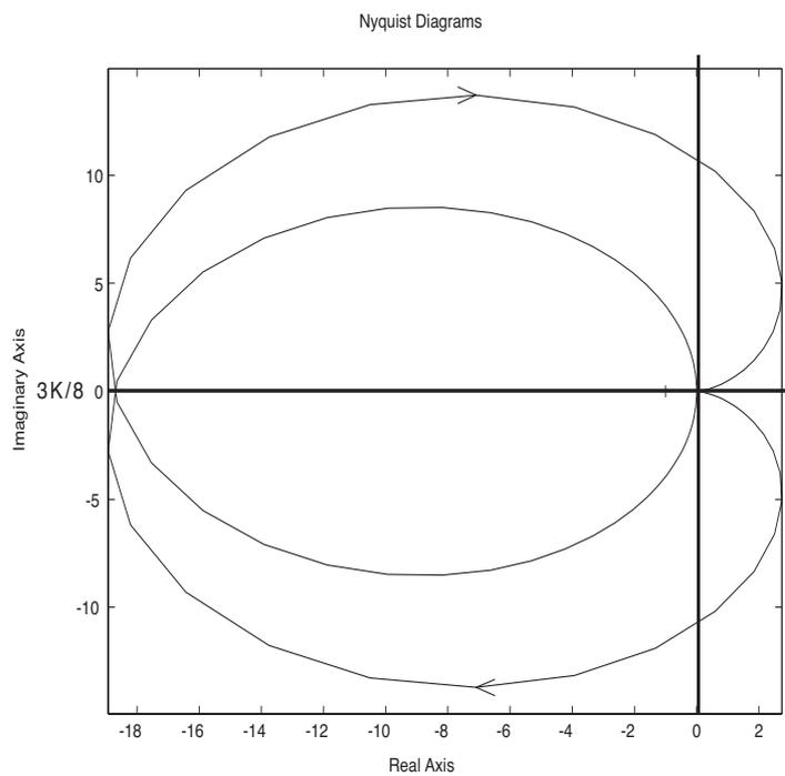
Risulta allora evidente, dal primo diagramma, che il sistema è BIBO stabile per ogni valore di  $K > 0$ . Nel caso del secondo diagramma, invece, è evidente che
