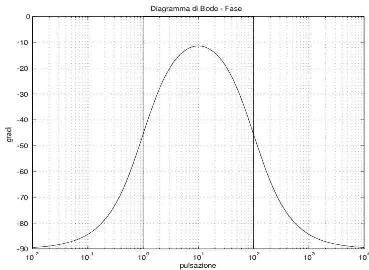
ed è immediato rendersi conto del fatto che la pulsazione  $\omega_A$  si trova esattamente in corrispondenza a  $10^3$  rad/s, mentre il margine di fase in corrispondenza alla pulsazione  $\omega_A^* = 700$  rad/sec è circa  $90^\circ$ . Per compensare il fatto che  $\omega_A > \omega_A^*$  e  $m_\psi(\omega_A^*) \approx m_\psi^* := 90^\circ$  potremmo utilizzare un'azione attenuatrice:
