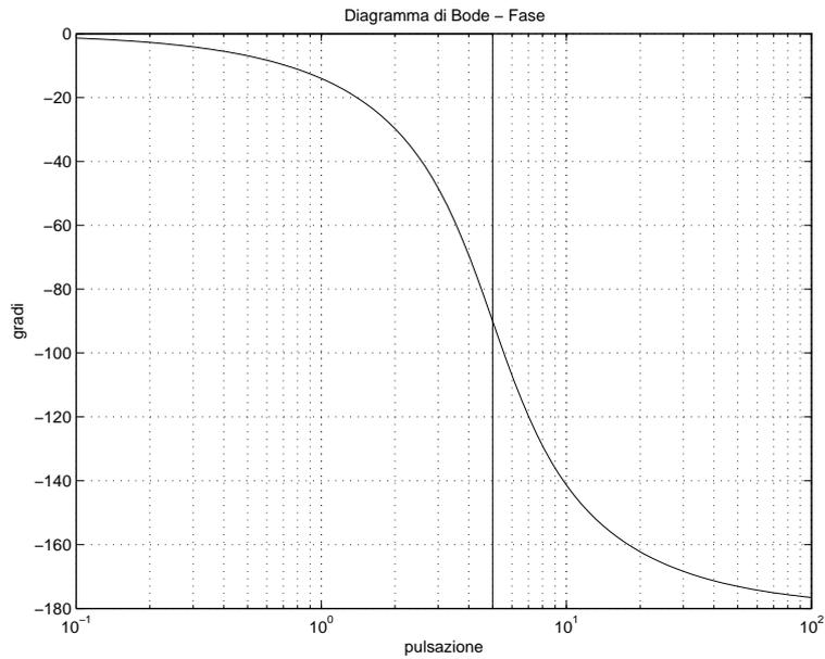
Si trova  $5 \cdot 10^{1/2} \text{ rad/s} = \omega_A < \omega_A^* = 50 \text{ rad/s}$  e  $m_\psi(\omega_A^*) := 180^\circ + \arg(C'(j\omega_A^*)G(j\omega_A^*))$  soddisfa  $0^\circ \approx m_\psi(\omega_A^*) < m_\psi^* = 70^\circ$ . Possiamo quindi applicare un'azione anticipatrice in modo da sollevare il diagramma delle ampiezze di  $20 \text{ dB} = -|C'(j\omega_A^*)G(j\omega_A^*)|$  e da sollevare il diagramma delle fasi di almeno  $70^\circ$ .
