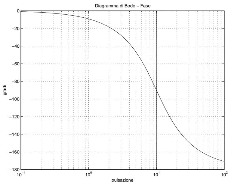
Si trova  $10^{3/2} \text{ rad/s} = \omega_A < \omega_A^* = 100 \text{ rad/s}$  e  $m_\psi(\omega_A^*) := 180^\circ + \arg(C'(j\omega_A^*)G(j\omega_A^*))$  soddisfa  $0^\circ \approx m_\psi(\omega_A^*) < m_\psi^* = 70^\circ$ . Possiamo quindi applicare un'azione anticipatrice in modo da sollevare il diagramma delle ampiezze di  $20 \text{ dB} = -|C'(j\omega_A^*)G(j\omega_A^*)|$  e da sollevare il diagramma delle fasi di almeno  $70^\circ$ .
