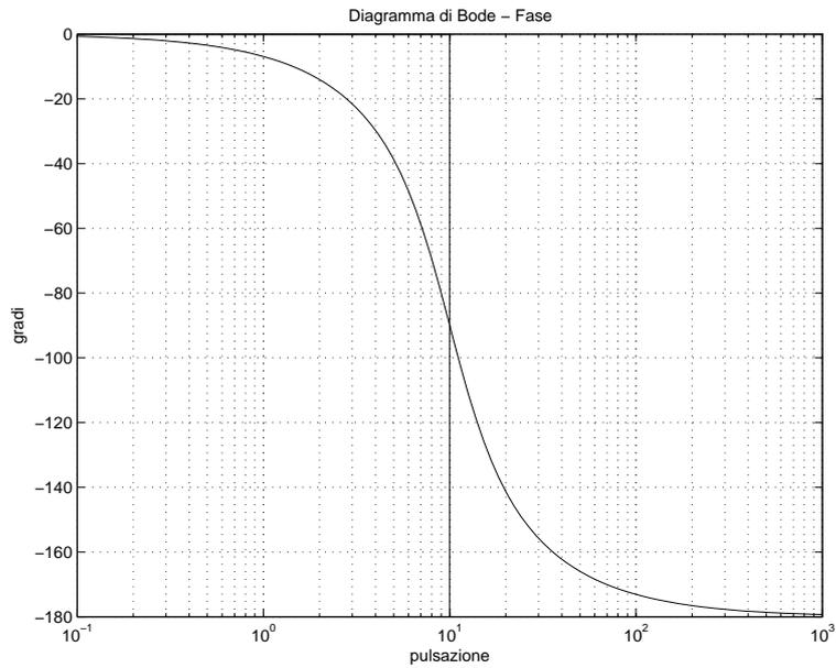
Si trova  $10^{3/2}$  rad/s =  $\omega_A < \omega_A^* = 100$  rad/s e  $m_\psi(\omega_A^*) := 180^\circ + \arg(C'(j\omega_A^*)G(j\omega_A^*))$  soddisfa  $0^\circ \approx m_\psi(\omega_A^*) < m_\psi^* = 70^\circ$ . Possiamo quindi applicare un'azione anticipatrice in modo da sollevare il diagramma delle ampiezze di 20 dB =  $-|C'(j\omega_A^*)G(j\omega_A^*)|$  e da sollevare il diagramma delle fasi di almeno  $70^\circ$ .
