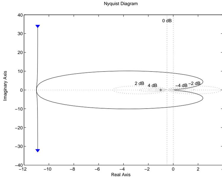
Si noti che il diagramma arriva, per  $\omega \rightarrow +\infty$ , con fase di  $270^\circ = -90^\circ$ , tuttavia per motivi puramente numerici questo fatto non è ben visibile dal diagramma. Stesso discorso vale per  $\omega \rightarrow -\infty$ , dove la fase è di  $90^\circ$ .
