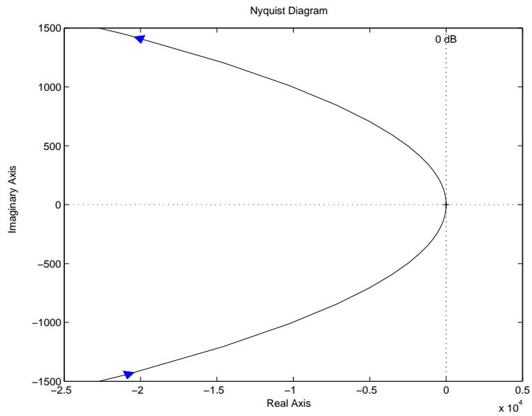
Si noti che il diagramma arriva, per  $\omega \rightarrow +\infty$ , con fase di  $-450^\circ = -90^\circ$ , tuttavia per motivi puramente numerici questo fatto non è ben visibile dal diagramma precedente. Riportiamo, pertanto, di seguito il dettaglio del diagramma in prossimità dell'origine.
