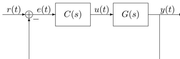
si progetti, se possibile, un controllore (razionale e proprio)  $C(s)$  in modo tale che a) il risultante sistema retroazionato risponda alla rampa unitaria in ingresso con errore di regime permanente pari a  $e_{rp}^* = 10^{-1}$ , b) la pulsazione di attraversamento del sistema in catena aperta sia all'incirca  $\omega_A^* = 10^{5/2}$  rad/sec e c) il margine di fase (del sistema in catena aperta) sia non inferiore a  $90^0$ .
