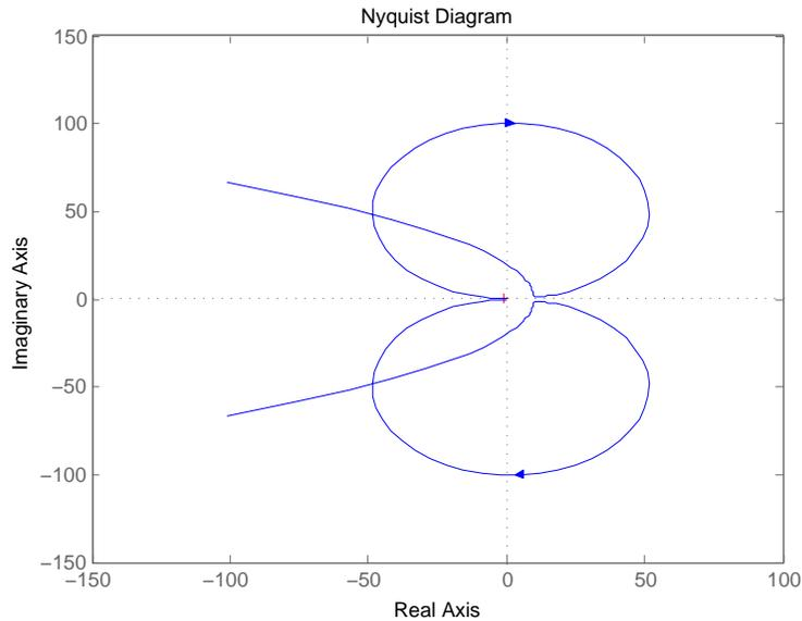
La chiusura del diagramma al finito avviene congiungendo il ramo superiore aperto con quello inferiore, nel semipiano reale negativo, in verso orario. Di conseguenza, il diagramma di Nyquist non compie nessun giro attorno a  $-1 + j0$ , ovvero  $N = 0$ . Poichè  $G(s)$  non ha poli a parte reale positiva, ovvero  $n_{G+} = 0$ , la condizione  $N = 0$  assicura  $n_{W+} = 0$ . Pertanto il sistema retroazionato è BIBO stabile.
