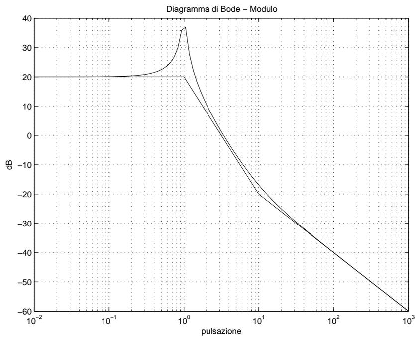
La pulsazione di risonanza esiste e coincide praticamente con  $\omega_n = 1$  rad/s. Il picco di risonanza relativo vale circa 20 dB. Infine, la banda passante a 3 dB assume un valore intermedio tra 1 e 2 rad/s.
