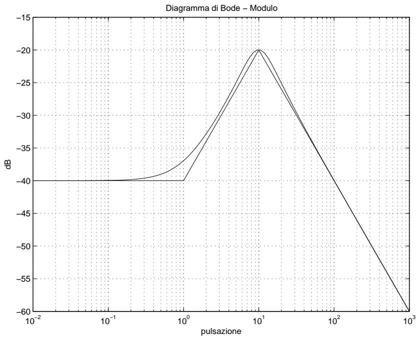
La pulsazione di risonanza esiste e coincide praticamente con  $\omega = 10$  rad/s. Il picco di risonanza vale circa 20 dB. Infine, poichè è immediato rendersi conto che il diagramma di Bode delle ampiezze assume valore pari a  $|K_B|_{dB} = -40$  dB in corrispondenza a  $\omega = 10^2$  rad/s, la banda passante a 3 dB assume un valore leggermente superiore a 100 rad/s (si può assumere, in prima approssimazione, 130 rad/s).
