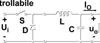
Se  $I_o = 0$  non c'è assorbimento di energia dal carico. L'energia fornita dall'alimentazione si accumula nel condensatore C, la cui tensione  $U_o$  cresce fino a stabilizzarsi al valore  $U_i$ .
