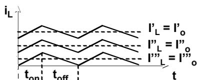
Se il carico si riduce ulteriormente, la corrente  $i_L$  può annullarsi, dando luogo al funzionamento discontinuo
