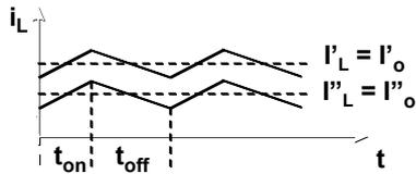
Se cambia il carico, a parità di tensione di uscita, cambia la corrente di uscita. Però  $\delta$  resta costante.
