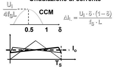
A parità di  $I_o$  l'intermittenza si ha per elevati valori di  $\Delta I_L$ , cioè con  $\delta$  nell'intorno di 0.5
