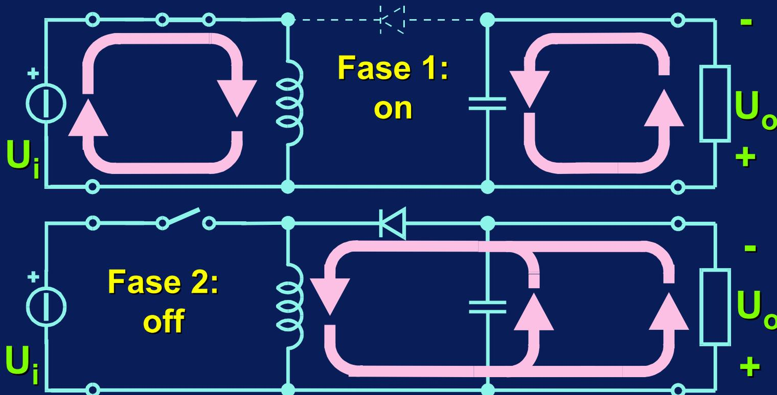
Il meccanismo di trasferimento di energia in due fasi (sorgente  $\rightarrow$  induttanza  $\rightarrow$  carico) consente di alimentare il carico a qualunque tensione
