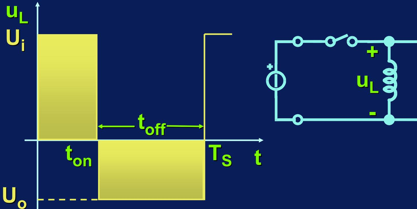
$$U_i \cdot t_{on} = U_o \cdot t_{off}$$
