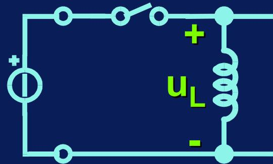
$$U_i \cdot t_{on} = U_o \cdot t_{off}$$
