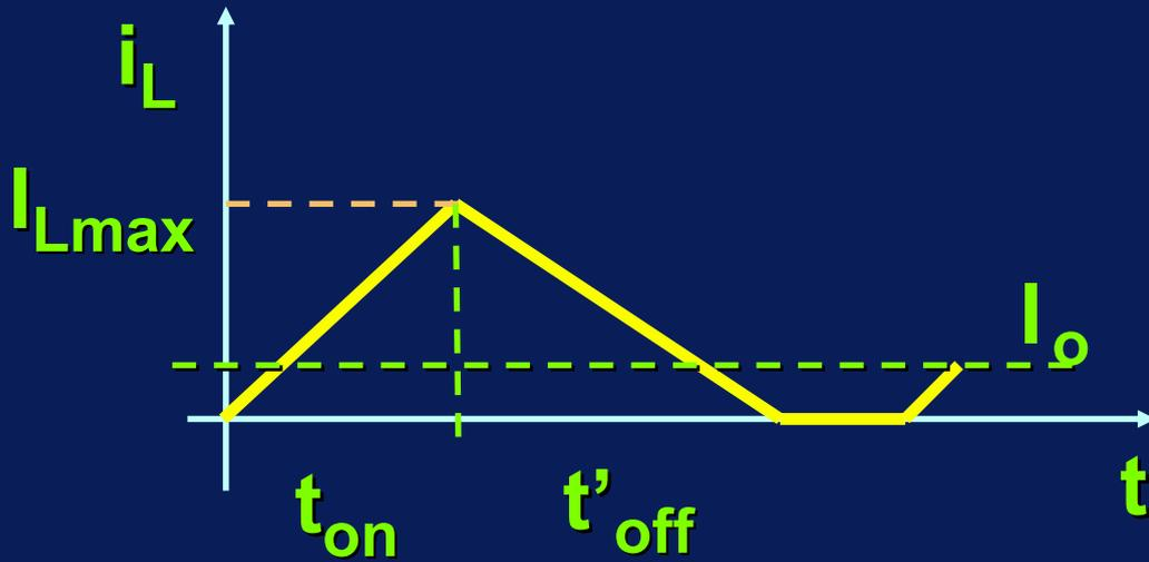
$$I_{Lmax} = \frac{U_i}{L} \cdot t_{on}$$
