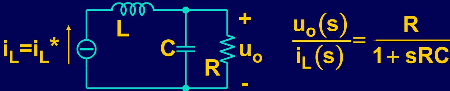
Si può allora sostituire il convertitore
