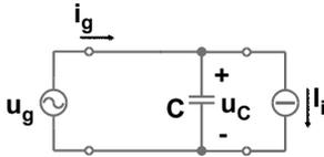
Questo modo di funzionamento inizia quando  $u_g = u_C$  e termina quando  $i_g = 0$
