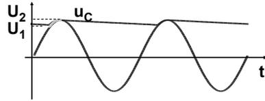
Forme d'onda durante  $t_{on}$  (D on)
