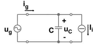
Questo modo di funzionamento inizia quando  $u_g = u_C$  e termina quando  $i_g = 0$
