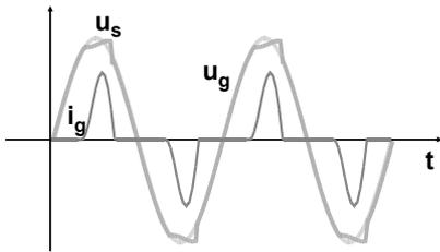
La distorsione di tensione si ripercuote anche sugli altri carichi connessi allo stesso nodo
