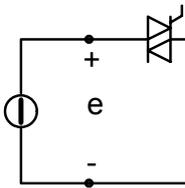
Come è noto, il triac è un componente che si comporta come una coppia di SCR connessi in parallelo in verso opposto, con un unico elettrodo di comando
