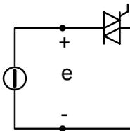
La regolazione è ottenuta ritardando l'accensione di un angolo  $\alpha$  rispetto all'inizio del semiperiodo. Si ottiene una semionda tagliata la cui componente fondamentale è inferiore a quella dell'onda piena
