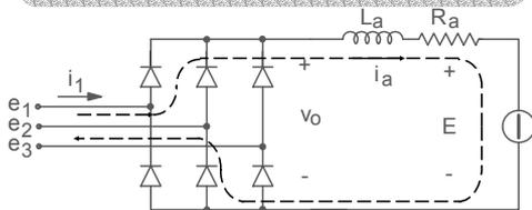
Vi sono sempre solo due diodi in conduzione contemporanea, uno nella parte superiore ed uno nella parte inferiore del ponte
