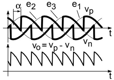
Il valore medio della tensione di uscita diminuisce all'aumentare dell'angolo  $\alpha$ . Tale valore medio diventa negativo per valori di  $\alpha$  maggiori di 90 gradi (funzionamento da invertitore)
