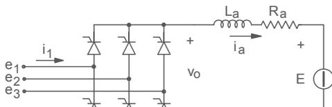
Sostituendo, sia nei ponti monofase che in quelli trifase, tutti i diodi con tiristori si ottengono ponti totalmente controllati
