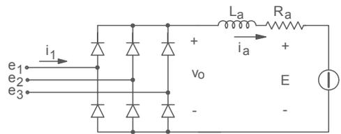
Nella parte superiore del ponte, conduce il diodo connesso alla fase la cui tensione istantanea è massima e, nella parte inferiore, il diodo connesso alla fase la cui tensione istantanea è minima
