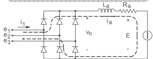
Il passaggio della conduzione da un diodo all'altro (commutazione) avviene naturalmente all'incrocio tra le forme d'onda delle tensioni di due fasi successive
