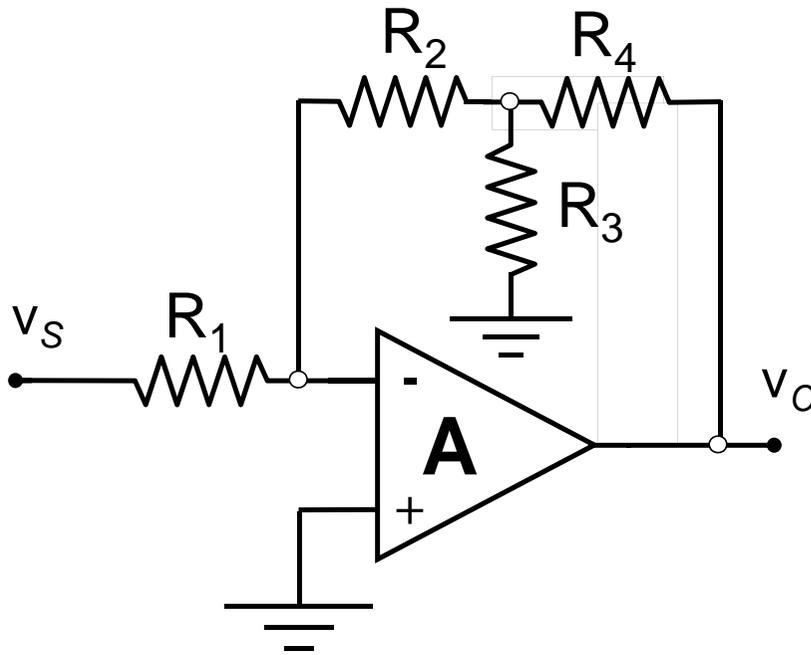
Per avere  $R_{IN}$  elevata metto  $R_1$  elevata. Con una opportuna scelta di  $R_2$ ,  $R_3$  e  $R_4$  si ottiene un guadagno  $|A|$  molto elevato.
