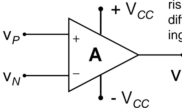
Tutte le tensioni sono misurate rispetto a massa, ma solo la differenza delle tensioni in ingresso determina l'uscita.
