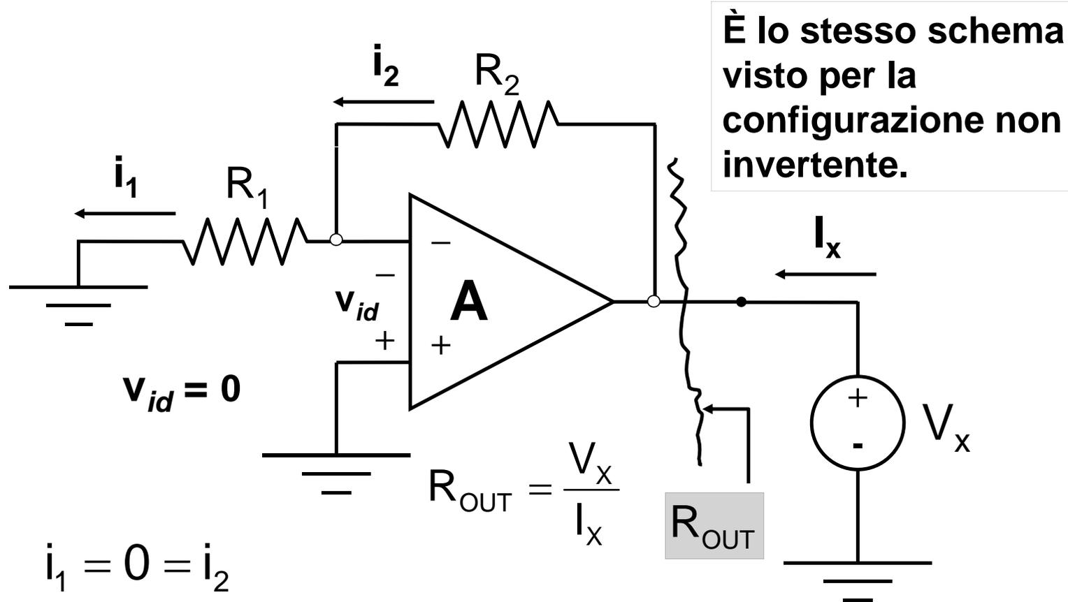
È lo stesso schema visto per la configurazione non invertente.
