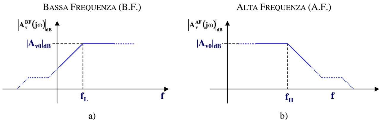
Figura 1- Possibili andamenti della risposta in frequenza di un amplificatore.
