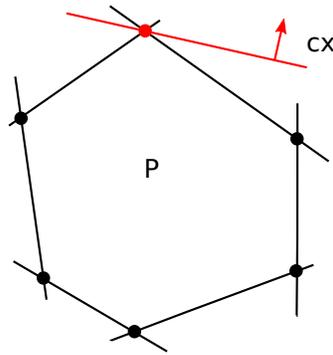
Figure 1: Interpretazione geometrica del teorema fondamentale della programmazione lineare.
