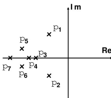
**Figura 2.1.** Poli del sistema strettamente stabile in catena chiusa ordinati in base alla parte reale.
