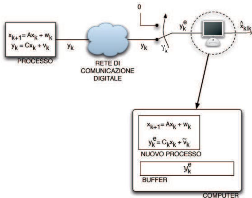
**Figura 5.1.** Schema generale di trasmissione delle misure attraverso una rete di comunicazione.
