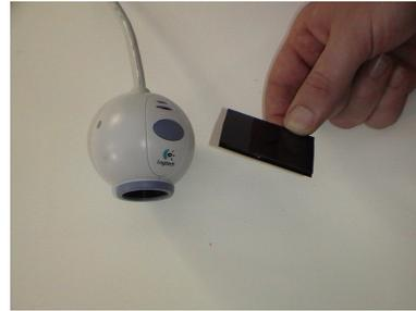
Fig. 18: Web-cam e filtro all'infrarosso
