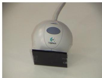
Fig. 9: Web-cam e filtro fissato su di essa
