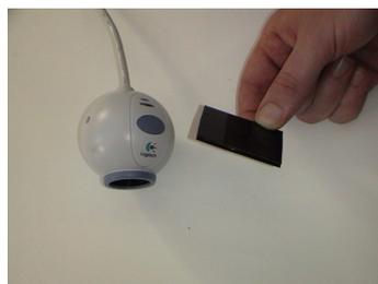
Fig. 8: Web-cam e filtro infrarosso
