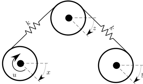
Si tratta di tre rulli di raggio  $R$  e momento di inerzia  $J$  che ruotano con attrito  $\beta$  attorno al loro asse e che sono connessi attraverso un cavo elastico con costante elastica  $k$ . Calcolare la funzione di trasferimento  $G(s)$  tra l'ingresso  $u$  e l'uscita  $y$ .
