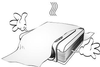
Se i fori di ventilazione sono ostruiti, il surriscaldamento dell'unità può provocare un incendio.
