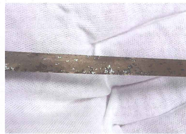
Un nastro magnetico deteriorato in modo irreparabile a causa di una perdita di particelle avvenuta durante la sua lettura.
