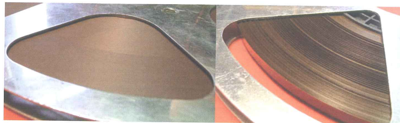
Nastro magnetico avvolto correttamente (a sinistra) e in modo errato (a destra). Un'archiviazione impropria del nastro, spesso causata da un sistema di riavvolgimento non perfettamente revisionato, provoca un rapido aumento del deterioramento del supporto, abbreviandone l'aspettativa di vita.
