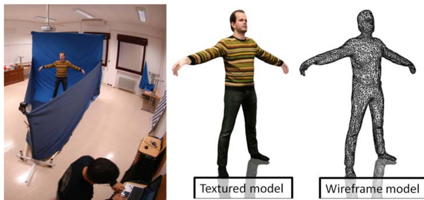
Figura 1. (Sinistra) Body Scanner, (Destra) modello 3D ottenuto.
