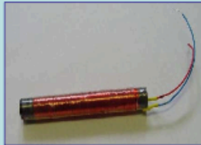
T. Sterken et al., 2005 IMEC, K.U. Leuven 300 \mu\text{W} , 50 \text{ g} @ 5 \text{ Hz} , 5 \text{ cm}^3
