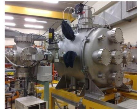
Attività sperimentale: test su chip/schede con acceleratori di particelle (memorie non-volatili, FPGA, microprocessori, transistor) presso laboratori nazionali e internazionali (INFN-LNL, CERN-CH, RAL-UK, HIF-B, RADEF-FIN, LANSCE-USA, TRIUMF-CAN, ...)
