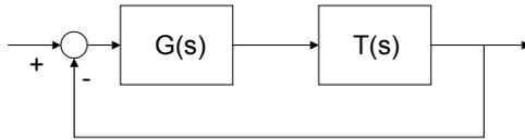
dove  $T(s) = \frac{2}{s+2}$ . É richiesto il calcolo del rapporto  $\frac{R_2}{R_1}$  e del prodotto  $RC$ , sapendo che il sistema ad anello é chiuso é stabile, risponde alla rampa unitaria con un errore a regime pari a  $e_{reg} = 0.1$ , ed ammette una pulsazione di attraversamento pari a  $\omega_c = 10$ .
