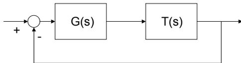
dove  $T(s) = \frac{5}{s+5}$ . É richiesto il calcolo del rapporto  $\frac{R_2}{R_1}$  e del prodotto  $RC$ , sapendo che il sistema ad anello é chiuso é stabile, risponde alla rampa unitaria con un errore a regime pari a  $e_{reg} = 0.01$ , ed ammette una pulsazione di attraversamento pari a  $\omega_c = 100$ .
