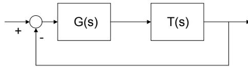
dove  $T(s) = \frac{5}{s+5}$ . É richiesto il calcolo del rapporto  $\frac{R_2}{R_1}$  e del prodotto  $RC$ , sapendo che il sistema ad anello é chiuso é stabile, risponde alla rampa unitaria con un errore a regime pari a  $e_{reg} = 0.01$ , ed ammette una pulsazione di attraversamento pari a  $\omega_c = 100$ .
