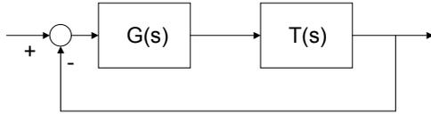
dove  $T(s) = \frac{2}{s+2}$ . É richiesto il calcolo del rapporto  $\frac{R_2}{R_1}$  e del prodotto  $RC$ , sapendo che il sistema ad anello é chiuso é stabile, risponde alla rampa unitaria con un errore a regime pari a  $e_{reg} = 0.1$ , ed ammette una pulsazione di attraversamento pari a  $\omega_c = 10$ .
