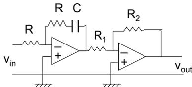
é richiesto di calcolare la funzione di trasferimento  $G(s)$  tra  $v_{in}$  e  $v_{out}$ . Si consideri quindi la seguente connessione in retroazione
