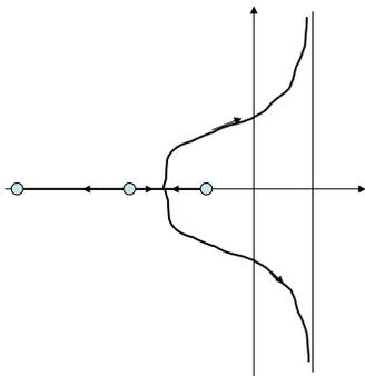
L'asintoto (verticale) é posizionato nel punto  $s = \frac{1}{4} = 0.25$ . Dalla figura é evidente che ci sará assenza di fenomeni oscillatori per  $K \leq \frac{7}{16}$ , e stabilitá per  $K < K_0$  ( $K_0$  essendo il valore per cui il luogo attraversa l'asse immaginario). Applicando ad esempio Routh, si ottiene il polinomio da studiare seguente
